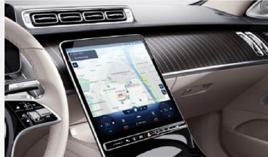
868 - 12,8" OLED Touchscreen med haptisk feedback og augmented reality
